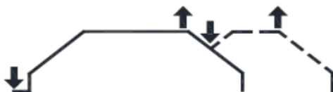
Рисунок 4. 2х тактный режим работы горелки
